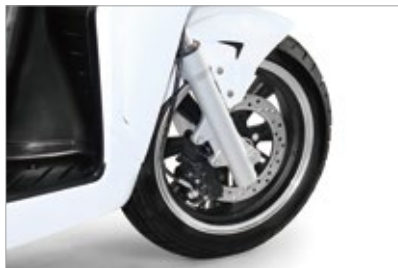
前後を連動させ安定した制動力を発揮する、コンビブレーキ(前後ともディスクブレーキ)
