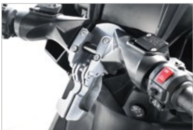
車両を垂直の状態に固定するロールロックレバーと、前後方向を固定するパーキングレバー
