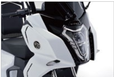
路面を明るく照らすと共に、被視認性を高めライダーの安全を確保する、LEDヘッドライト
