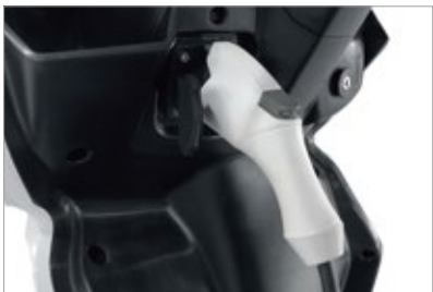
四輪車用普通充電器での充電を可能にするJ1772ソケットと付属の充電ケーブル
