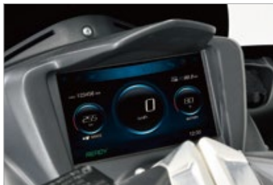
速度、電池残量、走行可能距離などをグラフィカルに表示する、フルカラー液晶メーター
